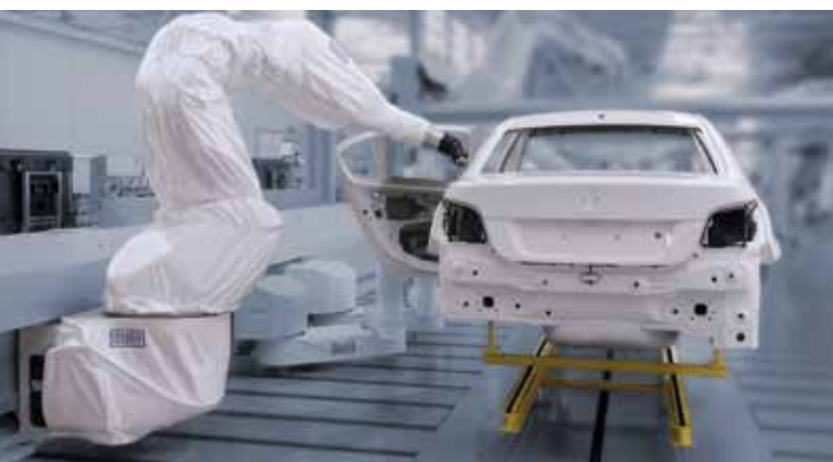
喷漆机器人、开门器、引擎盖开启器、随行轴
