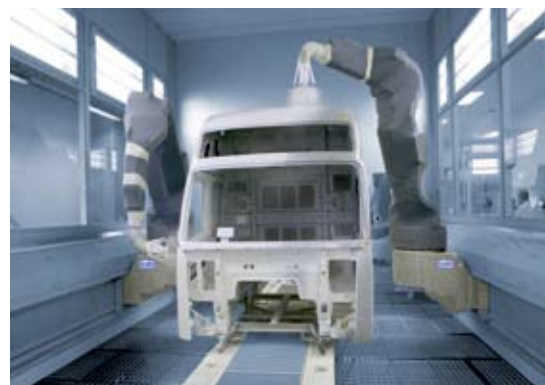
EcoBell2 SL Zerstäuber im Produktionseinsatz bei der Fahrerhauslackierung
