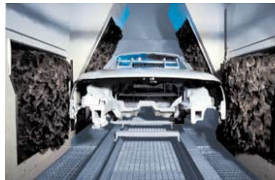
Karosseriereinigung mit der Schrägwalze und mit der Vertikalwalze
