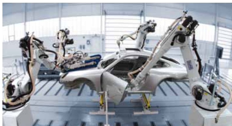
Roboter-Reinigungsanlage mit Schwertbürsten und Saug-Blaseinrichtung
