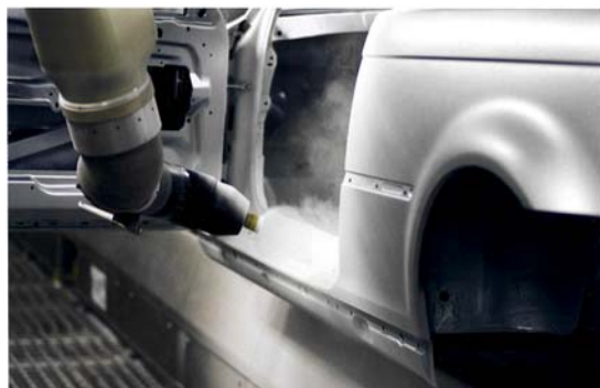
Zerstäuber EcoBell2 Powder bei der Lackierung von Türeinstiegen
