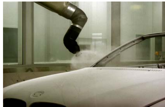
Zerstäuber EcoBell2 Powder bei der Außen- lackierung
