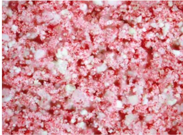
Trockene Agglomerate von Overspray und EcoDryLime
