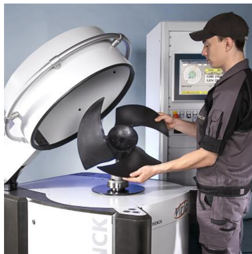
Die neue vertikale Auswuchtmaschine VIRIO von Schenck Rotec.
