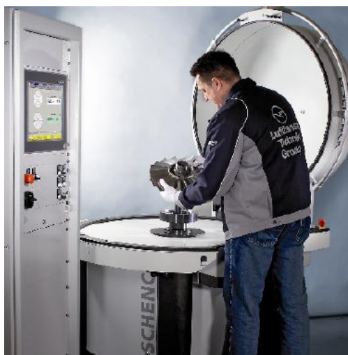
Vertikale Auswuchtmaschine V3L für Triebwerksrotoren
