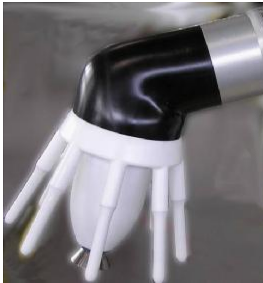
Der Lackzerstäuber EcoBell2 ICC ist flexibel einsetzbar.
