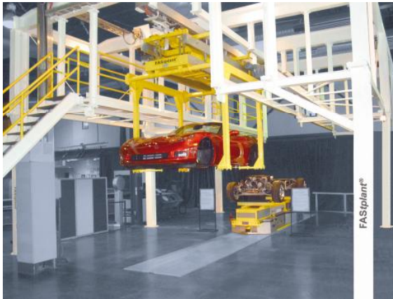
Darstellung der Aggregatmontage in einer FAS plant -Linie im Detroit Science Center.
