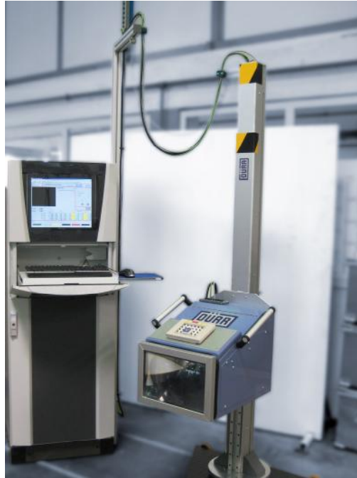
Das Prinzip x-light s basiert auf einer robusten und verschleißbarmen Präzisions-Führungssäule
