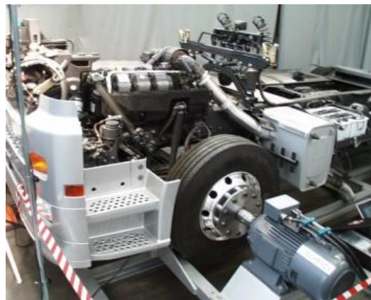
Hardware in the loop (HiL) mit Lkw.
