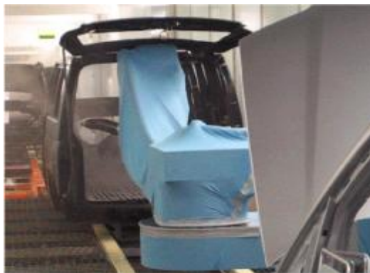
Swingarmroboter mit EcoBell2 Zerstäuber in Lackierstellung
