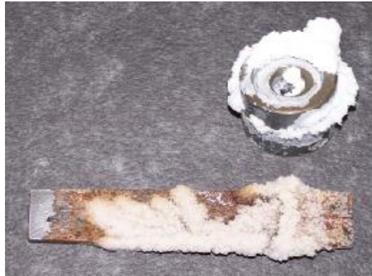
Harnsteinbildung und Korrosion waren Hürden bei der Befüllung mit Harnstofflösung.
