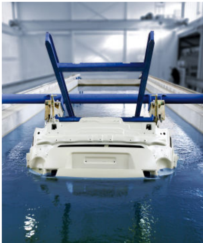
图：杜尔公司的 Ecopaint RoDip 翻转式浸涂系统，能改善涂装质量，降低成本。
