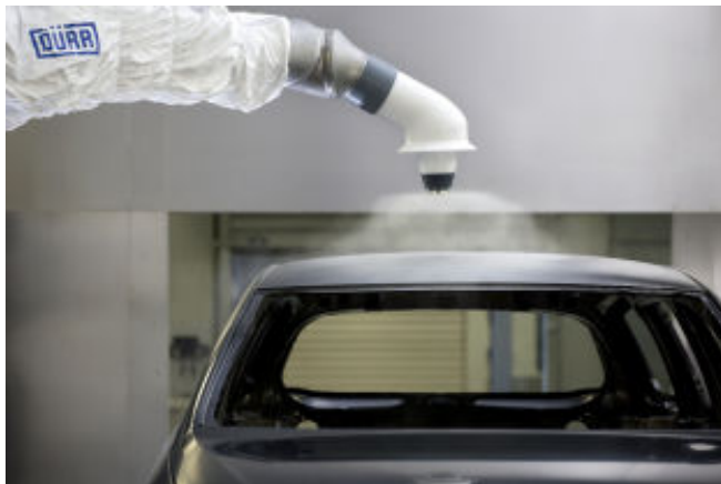
图 2: EcoBell3 雾化器用于外喷涂, 性能优异, 操作简单。
