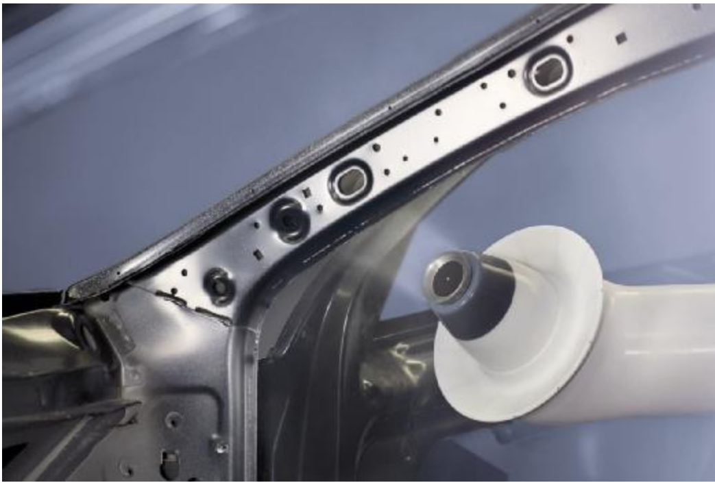
图 1：采用 EcoBell3 雾化器进行内喷涂，配有高速旋转喷嘴和直接供料装置。
