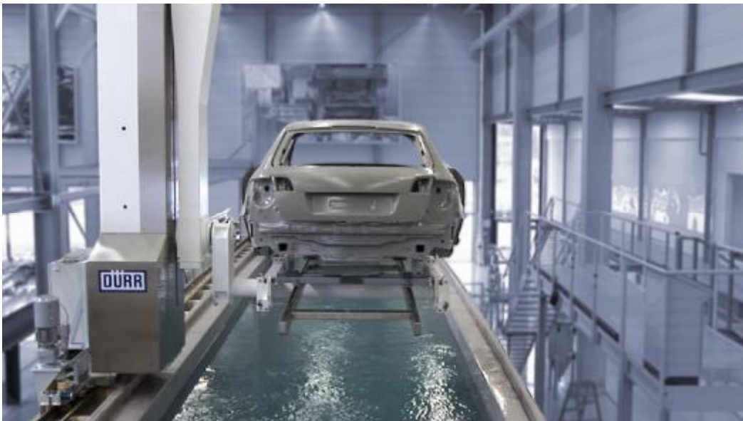
图 2: Ecopaint RoDip V 浸涂系统提供了最大的灵活性。车身在浸涂槽中能以任意编程的曲线进行线性运动或旋转运动。
