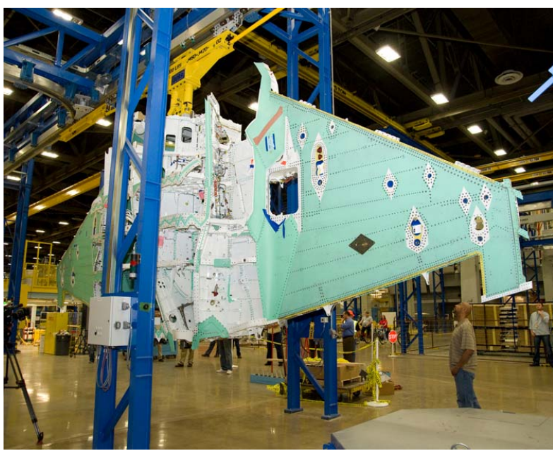
图 2：洛克希德马丁公司将 FASplant®重型模块应用于飞机装配中。
