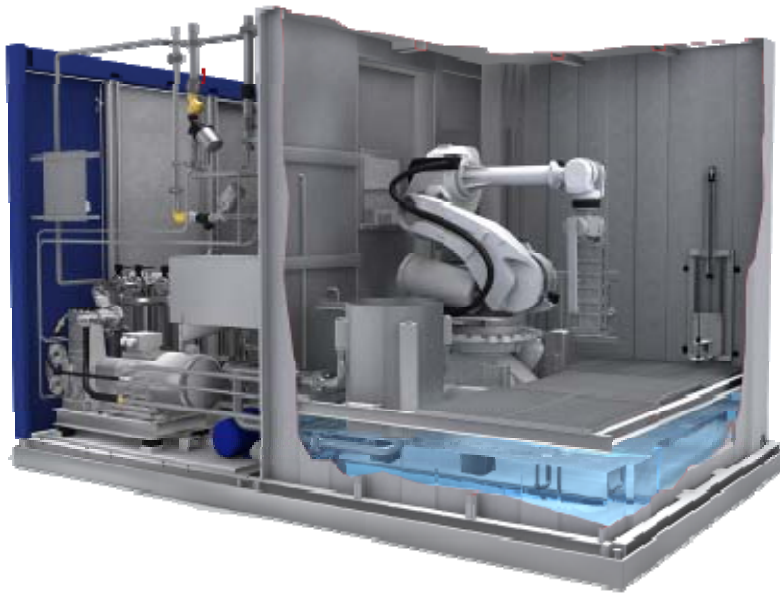
图 1: Dürr EcoClean 公司的 EcoCFlex 清洗系统能够完成多种清洗工艺。前部的中间是射流清洗槽，在后面可以看到高压单元。
