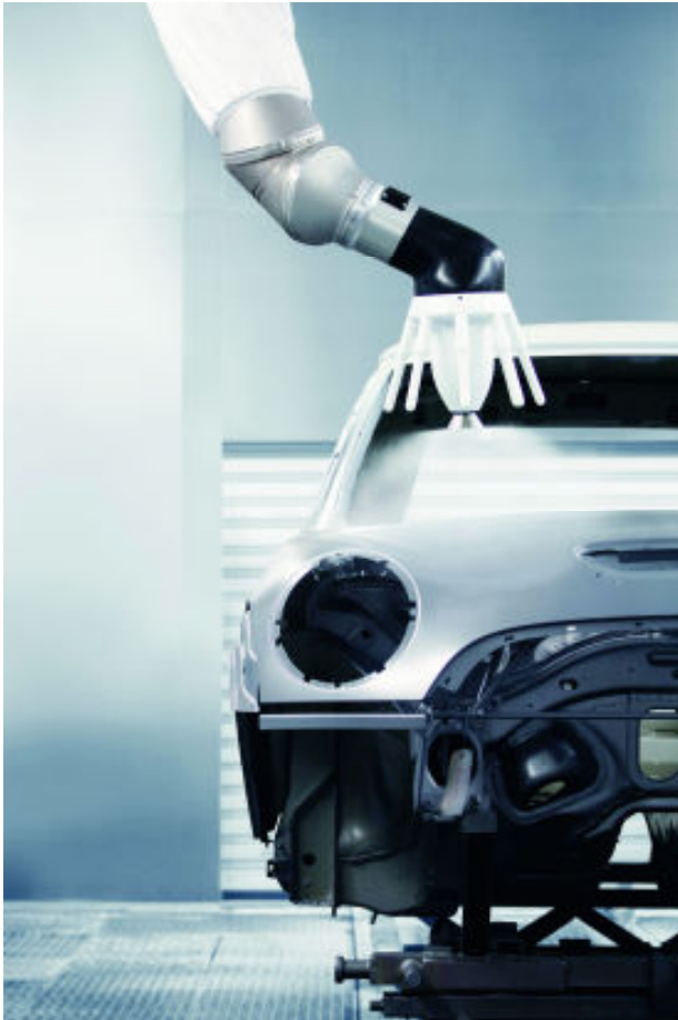
图 3：采用 EcoBell2 ICC 高速旋转雾化器缩短油漆换色的时间，提高了生产能力。
