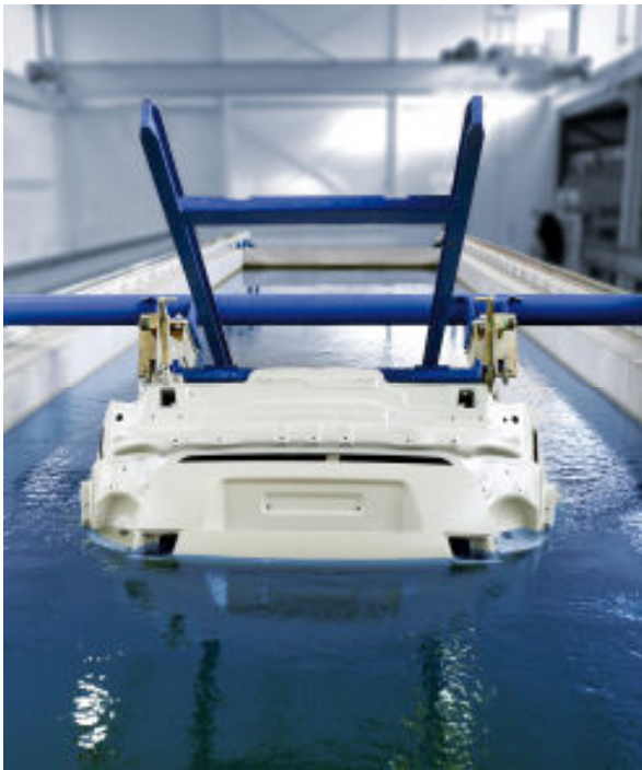
图 1：RoDip 旋转浸涂，既提高质量又降低成本。
