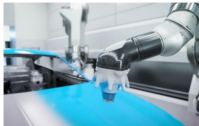
Innen- und Außenlackierung in einer Kabine mit der **EcoBell4 Ux Pro**.
