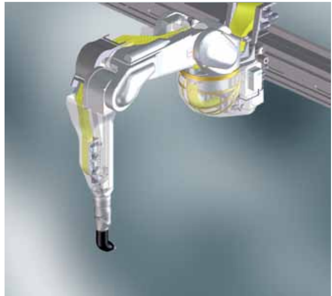
» Zentrale Schlauchführung durch die Roboterachsen
