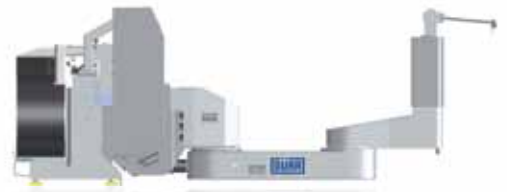
» EcoRP L130 (Scara) Türöffner, mitfahrend, mit 4 Achsen
