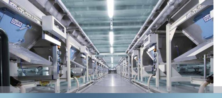
>>> Trockenabscheidung mit dem **Eco**DryScrubber bei BMW in Regensburg: Wartungsgang zwischen Abscheidetrichtern
