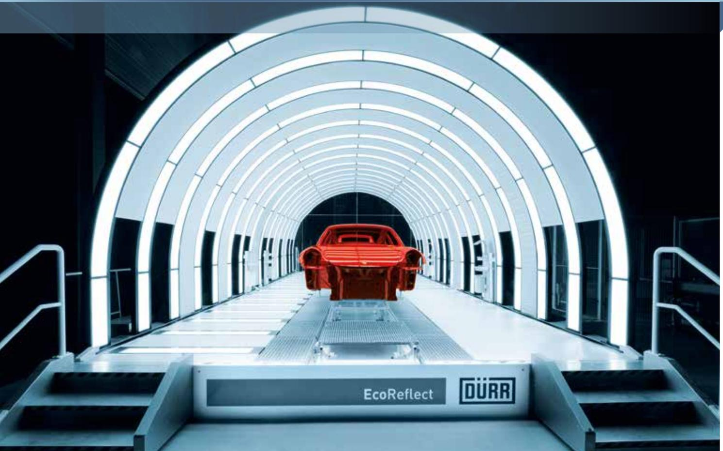
Der neuartige Lichttunnel **EcoReflect** bietet ideale Voraussetzungen für die zuverlässige Kontrolle der Oberflächenqualität.
