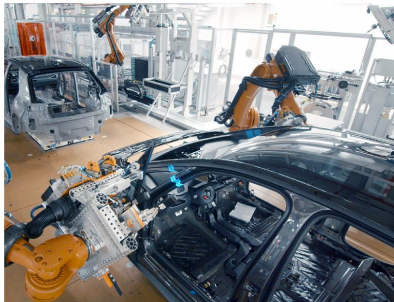
Mit dem neuesten Verfahren zum vollautomatischen Verkleben der Fensterscheiben im "Line-Tracking-Verfahren", erfolgt der Scheibeneinbau in das Fahrzeug automatisch bei laufendem Band.
