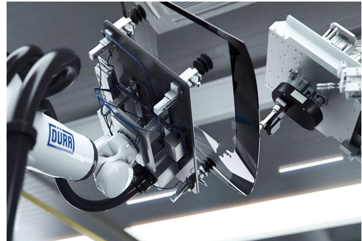
Das elektrische Dosiersystem EcoShot Meter garantiert im Zusammenspiel mit dem Applikator EcoGun formschlüssige Verbindungen von Nahtanfang bis -ende
