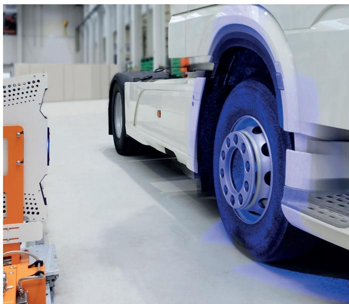
车轮定位台x-wheel truck *d*使用新的测量传感器x-3Dsurface
