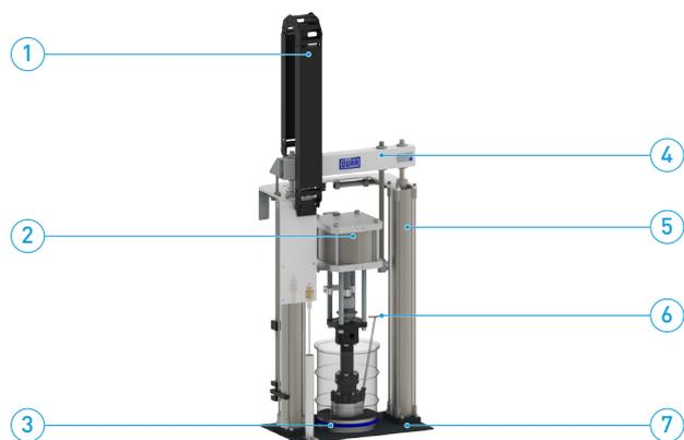
1 Energiekette, 2 Druckluftmotor, 3 Folgeplatte, 4 Heber, 5 Pneumatikzylinder, 6 Entlüftung, 7 Grundplatte
