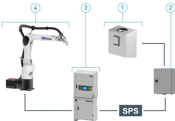
1 EcoGun CapCleaner, 2 Steuereinheit für Reinigungsgerät, 3 Robotersteuerung, 4 EcoRP 10 R1100, SPS Übergeordnete Lackiersteuerung
